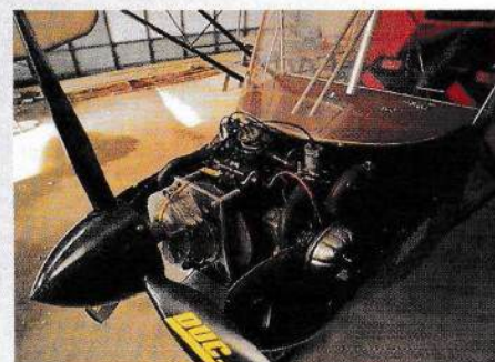
Le Chevron Volant Super Silencieux : Ce 4 temps sur base Citroën Visa concilie puissance et silence.
